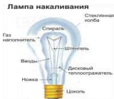
Рис.2. Устройство лампы накаливания и энергосберегающей лампы.
